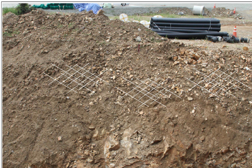
【그림 18】 B 영역 상세사진 (세편화된 암석)
